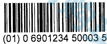
图 C.2 表示 13 位数字代码的 ITF-14 条码示例
