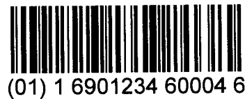
图 C.4 包装指示符为“2”的 ITF-14 条码示例
