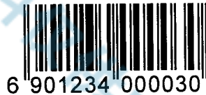
图 C.1 表示 13 位数字代码的 EAN-13 条码示例
