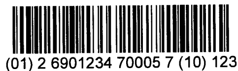
图 C.6 含批号“123”的 UCC/EAN-128 条码示例
