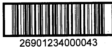
图 C.4 包装指示符为“2”的 ITF-14 条码示例
