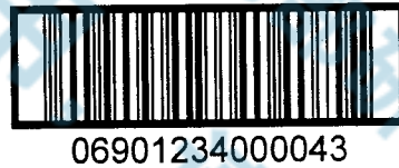
图 C.2 表示 13 位数字代码的 ITF-14 条码示例
